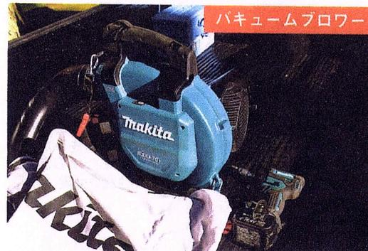
枝落とし後の木クズや落ち葉を吸い込んで片付けられる。アタッチメントの交換で吹き飛ばせるようになるのも気に入っている
