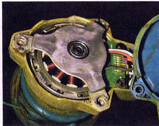
刈り払い機のモーター部分のカバーを外した様子。ゴムパッキンなどがなく、配線がむき出し。水の浸入による漏電などには注意が必要
